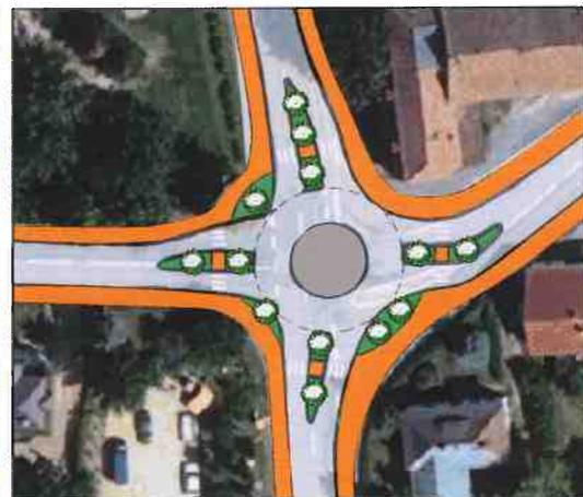
**Abb. 29:** Gestaltungsbsp. Minikreisverkehr Kittlitz
